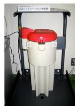
Naシンチレーション検出器外観図 日立アロカメテカル製
