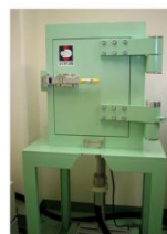
Ge半導体検出器外観図 セイコーイメージングアンドジー製
